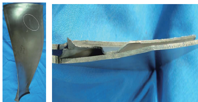
图5 2#试验件裂纹示意图
