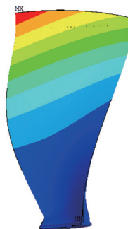
图6 风扇叶片一阶弯曲振型图
