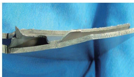
图14 2#试验件叶片断口全貌
