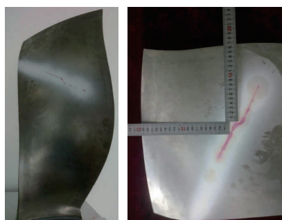
图4 1#试验件裂纹示意图
